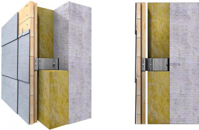
Abbildung 21: Aufbau einer hinterlüfteten Fassade | © RHEINZINK
